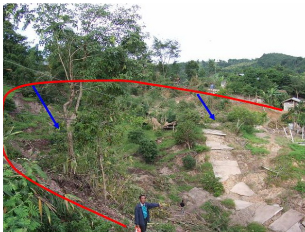
รูปที่ 6 ลักษณะของ Rotational slide ที่บ้านน้ำพิ อำเภอกู่ซ่าง จังหวัดน่าน เส้นสีแดงแสดงขอบเขตแนวที่เกิดการ slide เส้นสีน้ำเงินแสดงทิศทางการ slide
