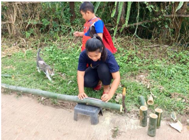
รูปภาพที่ 5 ตัดไม้ไผ่แ่ 1 ต้นแล้วนำมาวัด ขนาด 15 เซนติเมตรจากข้อถึง ปากกระบอกและขนาด 2 เซนติเมตรจากข้อไปก้นกระบอก
